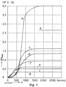
Energieinhalt von Magnetlegierungen (Funktion der Magnetisierungs-Feldstärke)
