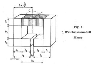
mit den zugehörigen Massen versehen ist. Am hergestellten Modell werden ausser bei I und 4 auch bei 2 und 3 je eine Wicklung angebracht (siehe Fig. 3) und die Flüsse unter gleichen Verhältnissen gemessen wie für  $\Phi_1$  und  $\Phi_4$ . Die Streuung lässt sich zunächst in 3 Faktoren trennen (siehe Fig. 5b):
