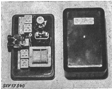
réseau à enroulements séparés, redresseur sec, résistances pour limiter l'intensité du courant de charge. Protection par deux petits coupe-circuit. Boîtier en matière isolante moulée noire, prévu pour fixation murale.
