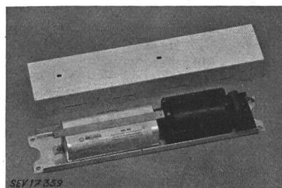
de 0,04  $\mu$ F en parallèle avec le réseau. Plaque de base et couvercle en tôle d'aluminium.
