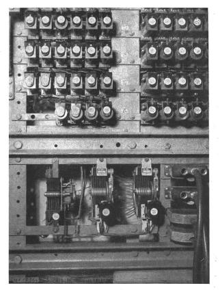
Fig. 1 Teil eines Relais-Schrankes oben: elektromagnetische Telephonrelais unten: 3 Schrittschalter zur Ausführung von immer gleich ablaufenden Operationen
