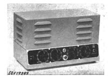
lateur d'entrée et touche de sélection de programmes de télédiffusion. Régulateurs d'intensité et de tonalité. Commutateur gramophone-télédiffusion. Translateur de sortie avec 6 prises. Transformateur de réseau à enroulements séparés. Protection par deux petits fusibles. Coffret en tôle avec couvercle vissé. Cet amplificateur est conforme aux «Prescriptions pour
