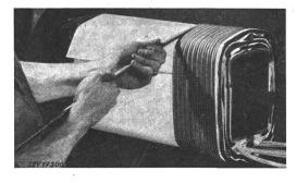
Fig. 3 Verwendung als Lagenisolation bei Trockentransformatoren
