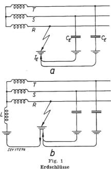
a nicht geerdetes Drehstromsystemb über Löschspule geerdetes System
