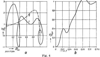
Leeranlauf eines Asynchronmotors a Drehmoment-Drehzahl-Charakteristik
