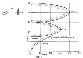
Stabilität eines Generators mit Seriekapazität
