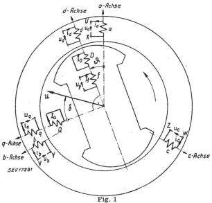
Zweipoliges Ersatzbild der Synchronmaschine
