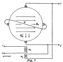
Prinzipschaltbild eines Amplidyne-Maschinenverstärkers 1;1' Eingangsklemmen; 2;2' Ausgangsklemmen; K Kurzschlusskreis;  $\phi_k$  Fluss erzeugt vom Kurzschlusskreis;  $\phi_k$  Erregerentwicklung;  $w_k$  Kompensationswicklung
