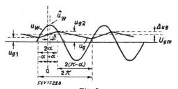
Fig. 5 Darstellung zur Berechnung der nötigen Wechselspannung
