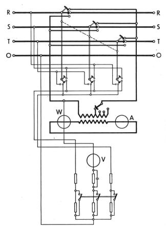
Fig. 2 Leistungsmesskoffer Ausgeführte Schaltung
