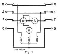
Leistungsmesskoffer für Einphasen- und Drehstrom Grundsätzliche Schaltung
