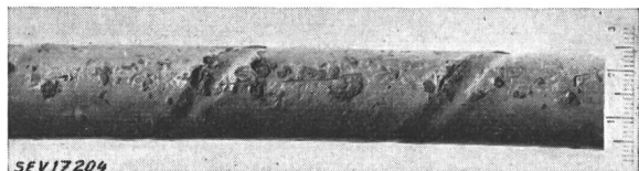
Fig. 4 Câble corrodé par du ciment
