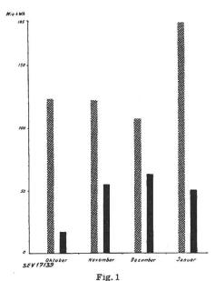
Speicherentnahme und Energie-Einfuhr vom Oktober 1949...Januar 1950 Säule links: Speicherentnahme Säule rechts: Energieeinfuhr
