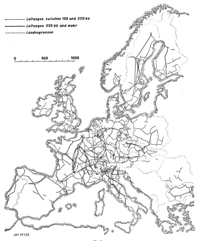
${\bf Fig.~2}$   ${\bf Gesamt-europ\"aisches~Hochspannungsnetz}$
