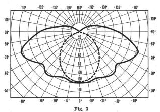
Lichtverteilungskurven der Armatur «Fluostra» Diagramm in der vertikalen Mittelebene parallel zur
