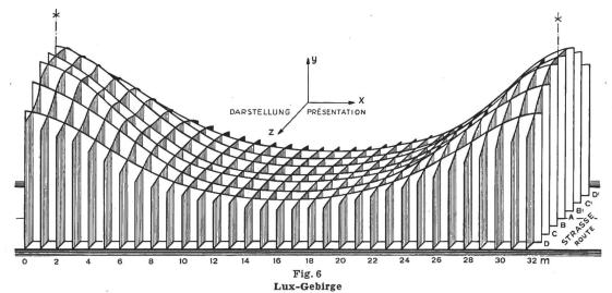
Darstellung des Verlaufes der Beleuchtungsstärken in Längsund Querschnitten durch die gemessene Bodenfläche
