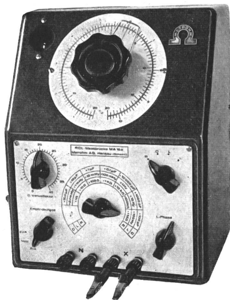
Fig. 2 RCL-Messbrücke MA 16A
