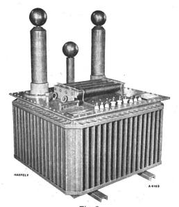
Fig. 3 Hochspannungs-Gleichrichter 120 kV, 35 mA dauernd für die Ladung einer Stossanlage für 60 kWs
