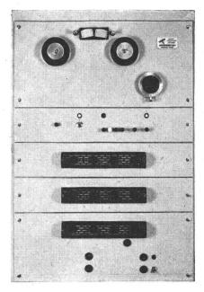
Fig. 1 Memofil-Zentrale mit Tastatur für Ortsbedienung
