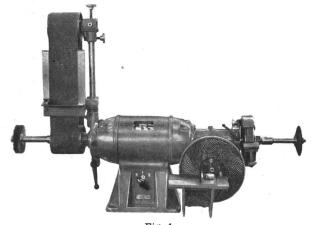
Fig. 1 Kombinierte Feil- und Bandschleifmaschine
