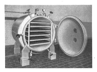
Fig. 2 Elektrischer Vakuum-Trockenschrank
