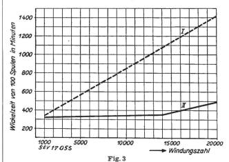
Wickelzeit für einen bestimmten Spulentyp auf der Handwickelmaschine (Kurve I) und auf dem Automaten (Kurve II)
