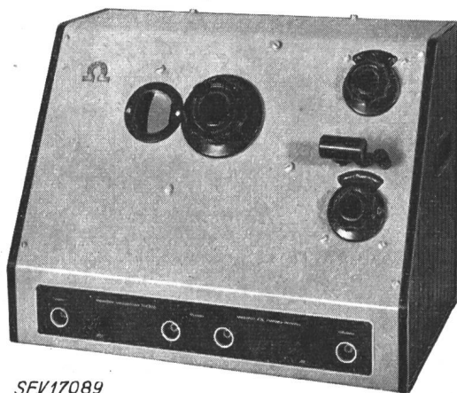
Fig. 3 Kapazitätsmessbrücke MA 80A
