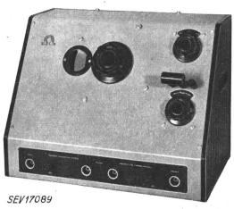
Fig. 3 Kapazitätsmessbrücke MA 80A
