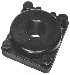
Fig. 2 Tragbarer Vielfachstromwandler
