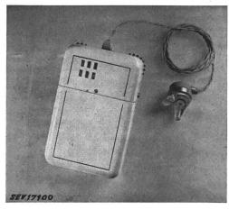
Fig. 1 Schwerhörigen-Verstärker «Orthophon-Suisse», Modell C
