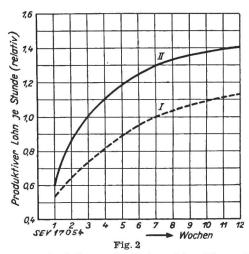
Anlernverlauf für Handwickelmaschine (Kurve I) und Automat (Kurve II)
