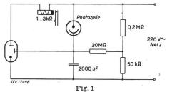
Schaltschema des Cerberus-Wechselstrom-Glimmrelais G 8, gesteuert durch Photozelle
