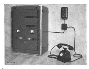
Fig. 2 Installation d'abonné raccordée par sans fil au réseau téléphonique public, avec station de table, coffret de distribution et indicateur de taxes
