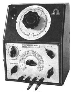
Fig. 2 RCL-Messbrücke MA 16A
