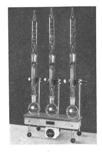
Fig. 3 Elektrische Heizplatte für Soxhlet-Extraktionsapparat
