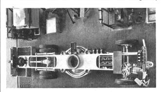
Fig. 1 Chassis des Gyrobus mit in der Mitte sichtbarem Schwungkörper
