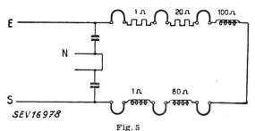
Montageschema der geeichten Leitungselemente in einer Leitungsschublade
