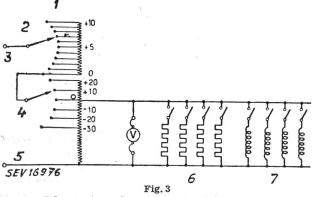
Schema einer ohmschen und induktiven Last
