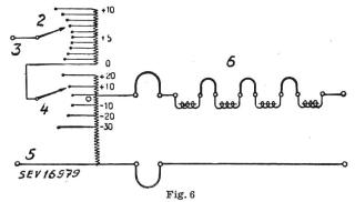
Schematische Darstellung eines Zweiwicklungstransformators
