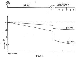
Spannungsabfall eines Steuerstromes bei tiefer und hoher Frequenz (Beispiel)
