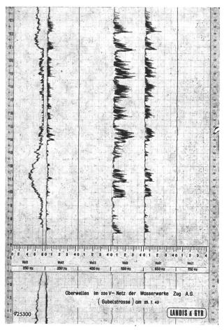
Fig. 2 Beispiel eines Registrierdiagramms der 5., 7., 9., 11., 13. und 15. Harmonischen
