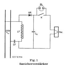
Dazu rüsten wir jeden Empfänger mit einem sehr einfachen Speicherverstärker nach Fig. 1 aus.
