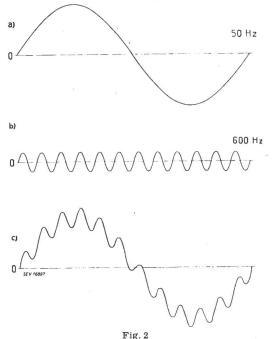
Uberlagerung von Netzspannung 50 Hz und Tonfrequenz 600 Hz
