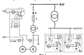
Prinzipschaltung einer Netzkommandoanlage nach dem Impuls-Intervall-Verfahren
