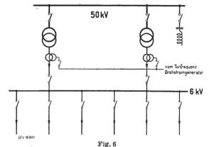
Serieüberlagerung gleichzeitig in alle Speiseleitungen der Mittelspannungsanlage
