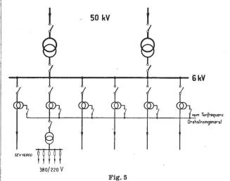
Serieüberlagerung nacheinander in jede abgehende Leitung des Mittelspannungsnetzes
