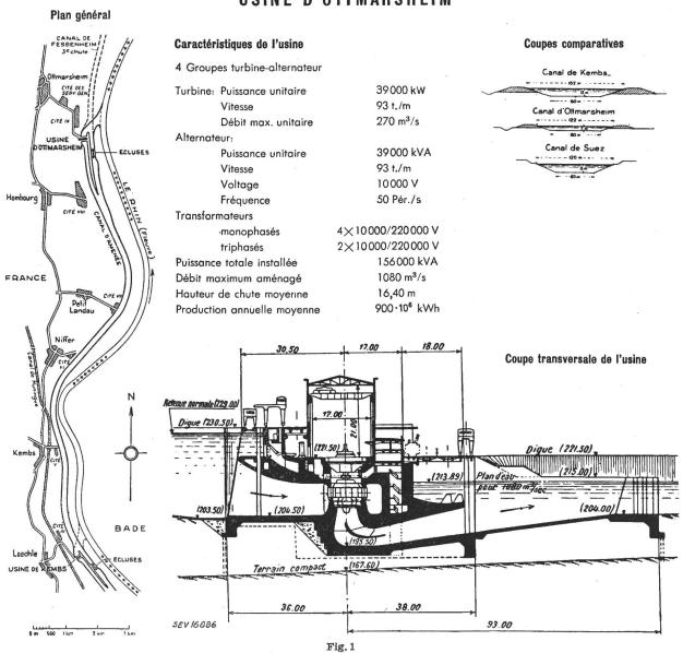
Kraftwerk Ottmarsheim Situationsplan und Schnitt durch das Maschinenhaus
