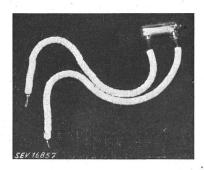
Ces interrupteurs basculants à mercure ont subi avec succès des essais conformes aux «Prescriptions pour les interrupteurs» (Publ. n° 119 f), pour les valeurs nominales de 6 A, 250 V  $\sim$ .
