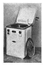
Machines à laver, selon figure, avec chauffage. Cuve à linge nickelée, avec agitateur tournant alternativement dans un sens et dans l'autre. Barres chauffantes disposées au fond de la cuve. Commande par moteur monophasé à induit en court-circuit avec phase auxiliaire et condensateur, ou moteur triphasé à induit en courtcircuit, attaquant directement un réducteur de vitesse à engrenages. Calandre à main sur la machine. Cordon de raccordement sous gaine de caoutchouc, fixé à la machine.
