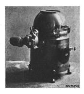
Machine à laver, selon figure, à chauffe électrique et commande par moteur triphasé à induit en court riphasé à induit en court riphasé à induit en court riphasé à induit en court plongeant dans la chaudière et dans le réservoir. Tambour à linge horizontal tournant alternativement dans un sens et dans l'autre. Bornes de raccordement montées sur céramique. Poignées en matière isolante moulée.
