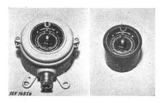
réglage de la durée s'opère au moyen d'une poignée tournante. Un bouton-poussoir sert à enclencher l'interrupteur et à faire fonctionner le mouvement d'horlogerie. Le modèle destiné aux locaux mouillés comporte un boîtier métallique avec vis de mise à la terre. Ces appareils sont livrables pour des durées maxima de 1, 2, 5, 15, 30, 60 et 180 minutes.
