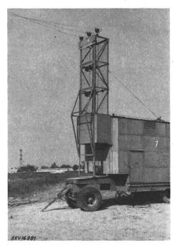
Fahrbare Transformatorenstation Die Hochspannungseinführung
