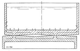
Fig. 2 Schematische Darstellung des Wärmeflusses in Kochplatten und Kochgeschirren
