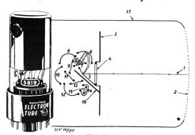
Fig. 10 Elektronenvervielfacher der RCA mit Beschleunigungselektrode
