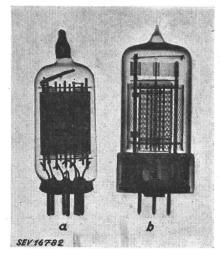
Fig. 2 Röntgenbild zum Vergleich von Bauart und Grösse einer amerikanischen Miniaturröhre (a) und einer Philips-Rimlockröhre (b)
