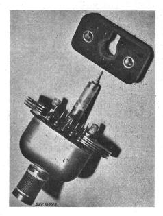
Fig. 12 25-W-Magnetron für Frequenzmodulation von 4000 MHz
