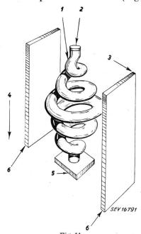
Fig. 11  ${\bf `Spiral-Beam-Control" - Methode\ zur\ Frequenz modulierung } \\ {\bf von\ Magnetrons}$
