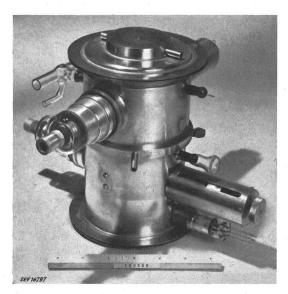
Fig. 17 1-kW-«Electron Coupler» für 800 MHz
