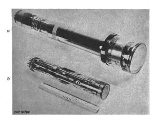
Fig. 8 Fernseh-Kameraröhren RCA-2P23 Image-Orthicon-Röhre «Mimo»-Kleinkameraröhre (RCA-2P22)
