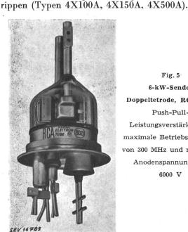
Fig. 5 6-kW-Sende-Doppeltetrode, RCA-8D21 Push-Pull-Leistungsverstärker für maximale Betriebsfrequenz von 300 MHz und maximale Anodenspannung von 6000 V
