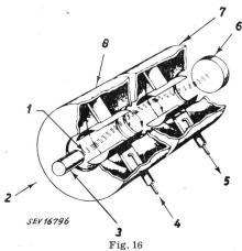
Schnitt durch einen «Electron Coupler»
