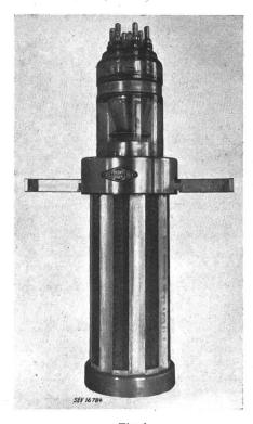
Fig. 4 Luftgekühlte Senderöhre mit Lamellenradiator
