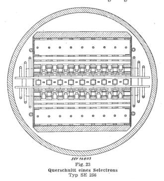
Für den Fall des Typs SE 256 ist die Anordnung aller dieser Elektroden in Fig. 23 gezeigt. Die Operationen dieser Röhren sind sehr kurzfristig, in der Grössenordnung von Mikrosekunden. Die Speicherfähigkeit ist unbegrenzt und es können durch Impulsanlegen beliebig viele Zwischenresultate abgenommen werden.
