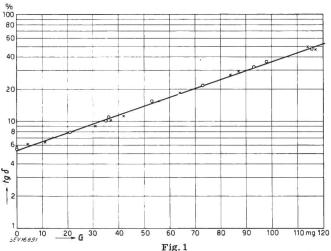
Verlustwinkel tg∂einer baumwollisolierten Doppelader in Abhängigkeit von der Wasseraufnahme G
