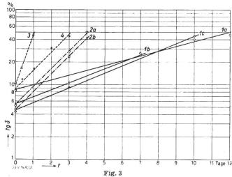
Bestimmung der Feuchtigkeitsdurchlässigkeit von Thermoplast-Schläuchen
