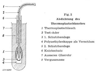
ader 2 eingezogen. Die Enden sind durch eine Bandage 3 und durch dickwandige Kappen aus Polyaethylen 4 verschlossen, diese durch eine paraffinierte Bandage 5 dick bewickelt und das Ganze mit einem Schutzrohr 6 in einem grossen Reagenzglas 7 mit Paraffin 8 vergossen. Da die Diffusionskonstante von Paraffin sehr hoch liegt und ausser-
