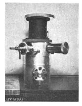
Fig. 11 Kathodenkopf mit Messblende und Leuchtschirm zur Ausmessung von Elektronenstrahlen
