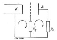
Fig. 1 Normale Verstärker-Schaltung Kathoden-Basis-Schaltung Anode
