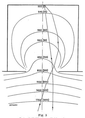
Potentialfeld einer Hohlanode Anodenpotential 500 V, Elektrodenpotential des Leistungsfeldes 2000 V Flugbahn eines Primär- und eines Sekundär-Elektrons (Wiederaustritt aus der Hohlanode)
