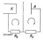
Fig. 6 Triode in Gitter-Basis-Schaltung Anode K Kathode Anodenwiderstand  $R_{\rm a}$ Gitterwiderstand
