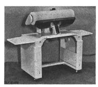
trapézoïdale et d'un réducteur à engrenages. Bâti en tôle. Moteur monté sur caoutchouc. Régulateur de température ajustable, deux interrupteurs unipolaires pour le moteur et le chauffage, lampe de signalisation. L'accouplement et le désaccouplement, ainsi que la pression du rouleau contre la plaque chauffante, s'opèrent à l'aide de deux leviers. Cordon de raccordement à trois conducteurs sous gaine de caoutchouc, fixé à la repasseuse, avec fiche 2 P + T. Poids 53 kg.
