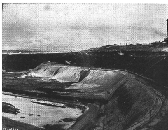
Fig. 1 Abbau der Braunkohlenschicht Das Wasserbecken im Vordergrund dient zur Speicherung des Löschwassers im Brandfall
