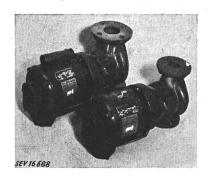
liaire du moteur n° 2, avec condensateur en série, n'est enclenché que durant le démarrage. Interrupteur thermique incorporé. Boîte en fonte pour le raccordement de l'amenée de courant.
