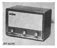
diffusion-gramophone et commutateur spécial pour basses. Transformateur de réseau et translateur d'entrée à enroulements séparés. Coffret en bois de  $340 \times 235 \times 180$  mm.
