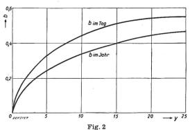
Belastungsfaktor über dem Relativmass der Werk-Durchschnittsleistung
