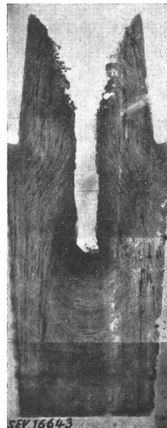
Fig. 6 Saugtrichter eines im Sand abgegossenen Stahlblockes (Baumannabdruck)
