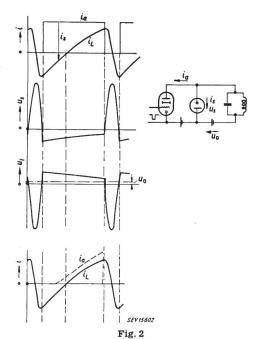
Diode mit Vorstrom als bipolarer Schalter
