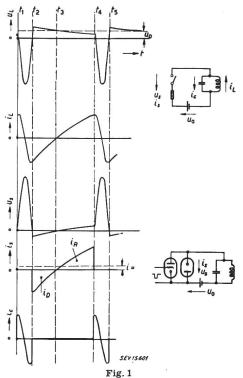
SZ-Strom-Erzeugung bei  $L/R \gg T$  mittels Schalterbetätigung und Darstellung eines bipolaren Schalters durch Röhrenanordnungen
