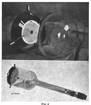
Prototipi di tubi generatori segnale di linea e d'immagine
