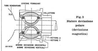
Con tale tipo di statore, così come schematizzato nella fig. 3 i risultati furono perfetti sotto ogni punto di vista per cui anche la rotazione completa dello statore non modificava sul controllo polare nè l'uniformità di moto nè la geometria del cerchio nè la sua posizione sul disco.
