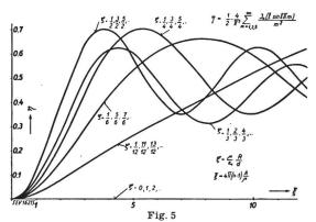
Lichtwirkungsgrad bei unendlich vielen Spalten bei sinusförmigem Phasengitter
