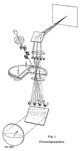
messungen solcher Braunscher Röhren ziemlich gross, vor allem sind grosse Durchmesser des Hohlspiegels der Schmidt-Optik erforderlich. Bei den grossen Spiegelabmessungen soll die Projektionsachse ziemlich genau senkrecht auf der Leinwand stehen, damit keine Randunschärfe zustande kommen kann. Die Aufstellung eines solchen Gerätes kann nicht beliebig erfolgen.
