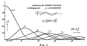
Intensität der verschiedenen Ordnungen von Beugungsbildern bei sinusförmigem Phasengitter
