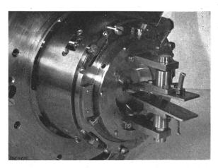
Fig. 16 Kathodensystem mit Ablenkplatten zur Modulation
