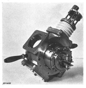
Fig. 22 Kathodenstrahlrohr
