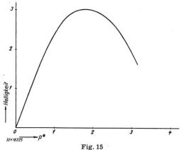
Steuerkennlinie des Modulationsverfahrens
