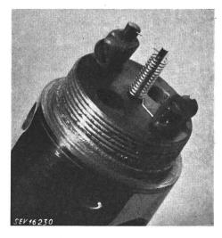
Fig. 20 Kathodenbolzen und Glühwendel
