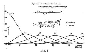
Intensität der verschiedenen Ordnungen von Beugungsbildern bei dreieckförmigem Phasengitter
