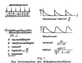
lauf muss hingegen nach Ablauf einer Bilddauer wieder abgeklungen sein, damit das nächste Bild geschrieben werden kann. Fig. 7 zeigt einen Querschnitt durch die Steuerschicht. Wir betrachten vorerst den Fall eines schwarzen Bildes. Der Kathodenstrahl schreibt mit konstanter Intensität auf die
