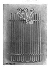
Corps de chauffe, selon figure, pour montage dans les chaudières de machines à laver. Trois barres chauffantes pour courant triphasé sous gaine en cuivre de 9/18 mm de diamètre, chacune pour un tiers de la puissance de chauffe. Serpentins cintrés. Extrémités des résistances de chauffe isolées par des perles et conduites à des bornes montées sur un socle en matière céramique.
