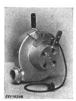
Petit brûleur à mazout, selon figure. Pompe et ventilateur entraînés par moteur monophasé à induit en court-circuit. Le mazout est amené par la pompe dans une cuvette à brûleur, où il est allumé à la main. Le débit du mazout et celui de l'air de combustion sont réglables. Interrupteur à levier basculant incorporé. Cordon de raccordement fixé la machine, avec prise 2 P + T.
