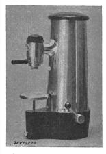
Percolateur, selon figure, dont les parties sous tension sont normalement en contact avec l'eau. L'eau est chauffée dans un récipient, isolé des autres parties métalliques, dans lequel des électrodes sont in-troduites. Le percolateur comprend des accessoires pour la préparation du café ainsi qu'un thermomètre à aiguille, un interrupteur et des lampes-témoins, encastrés. Le raccordement du cordon d'alimentation s'effectue au moyen de bornes fixes.
