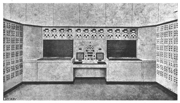
Fig. 1 Wechselstromnetzmodell der Associated Electrical Industries Ltd., London
