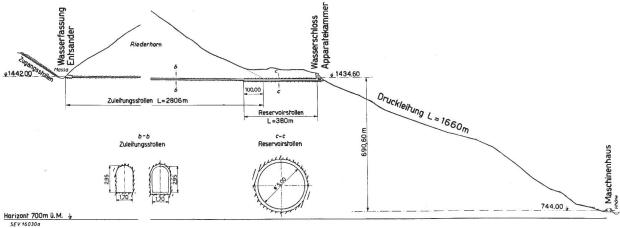
Fig. 2 Übersichtslängenprofil
