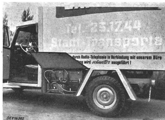
Fig. 13 Camionnette de l'entreprise Welte-Furrer équipée d'une installation radiotéléphonique
