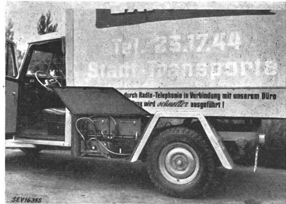
Fig. 13 Camionnette de l'entreprise Welte-Furrer équipée d'une installation radiotéléphonique
