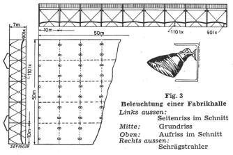
Da bei der Projektierung die genaue Position der Maschinen noch nicht festlag und dem Umstand Rechnung getragen werden musste, dass spätere Veränderungen in der Aufstellung der Maschinen vorzunehmen wären, wurde als Grundbedingung eine völlig gleichmässige, schattenarme Beleuchtung mit einer Helligkeit von rund 100 Lux in Arbeits-
