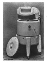
Machine à laver, selon figure, sans chauffage. Commande par moteur monophasé ventilé à induit en court-circuit, avec phase auxiliaire et interrupteur centrifuge, attaquant un réducteur à engrenages. Agitateur tournant alternativement dans un sens et dans l'autre. La machine est équipée d'une calandre pivotable à rouleaux en caoutchouc, de même que d'une pompe incorporée. Cordon de raccordement à trois conducteurs, sous double gaine isolante, fixé à la machine, avec fiche 2P + T.
