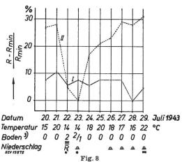
Widerstandsänderung bei Niederschlägen  $R_{\text{min} \, l} = 190 \, \, \Omega$   $R_{\text{min} \, l} = 40.6 \, \, \Omega$
