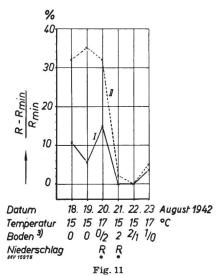
Einfluss des Gewitters auf den Erdungswiderstand  $\begin{array}{cccc} R_{\text{min I}} = & 196 & \Omega \\ R_{\text{min II}} = & 40,6 & \Omega \end{array}$
