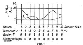
Widerstandsänderung während Temperaturschwankungen  $R_{\min I}$  bei Erdung I  $= 66 \Omega$   $R_{\min I}$  bei Erdung II  $= 432 \Omega$  Schneedecke an allen Tagen
