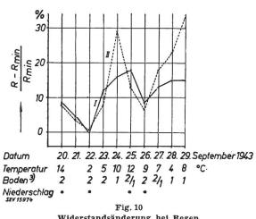
$\begin{array}{cccc} \textbf{Widerstandsänderung bei Regen} \\ & R_{\min \ |} = 156 \ \Omega \\ & R_{\min \ |} = 32 \ \Omega \\ \\ \textbf{Regen am 20., 22., 25. und 26. September} \end{array}$
