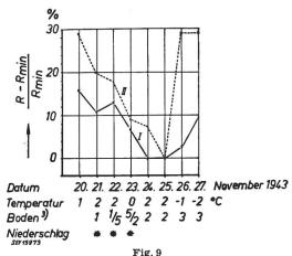
Widerstandsänderung bei schmelzendem Schnee $R_{\min 1}=220~\Omega \ R_{\min 1}=38~\Omega \ Schnee am 21...23. November$
