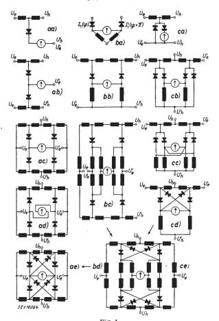
Fig. 4 Entwicklung des höchstsymmetrischen Modulators In verschiedener Reihenfolge werden die Operationen G (Gegentakt), B (Brücke) und V (Vollweg) auf eine Grundschaltung ausgeübt
