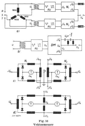
$a\ N_1,\ N_2$  Einfachmodulatoren gemäss Fig. 16c  $b\ DM$  Doppelmodulator gemäss Fig. 16d
