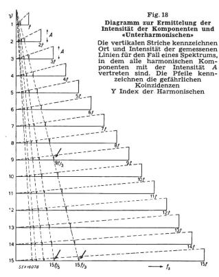
Vertikalstriche, d. h. der Intensität  $A/v_s$ , ist aus dem Diagramm leicht ersichtlich. Da man die Grundfrequenz f der zu analysierenden Spannung immer kennt, weiss man, wo «Hauptlinien» und wo «Satelliten» im Spektrum zu erwarten sind. Letztere werden stören, wenn sie mit einer Hauptlinie zusammenfallen, im Diagramm also auf einer vertikalen Linie liegen. Der gefährlichste Fall ist das Zusammentreffen von  $f_s = 9 f/3 = 15 f/5$  mit 3f.
