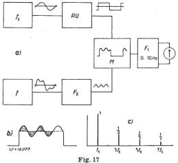
Harmonische Analyse von Spannungskurven
