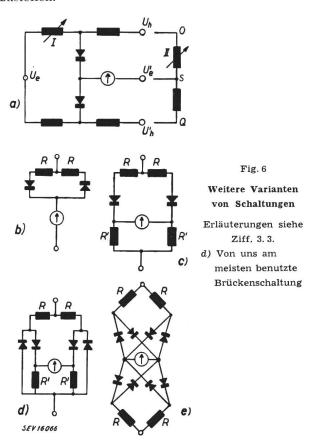
Brücken erhält man beispielsweise aus den entsprechenden Schaltungen für den Modulator unter Weglassung aller Elemente, die die eingekoppelte Spannung  $U_e...U_{e'}$  zuführen. Die wichtigsten Formen, die man so bekommt, zeigen Fig. 6b bis e. Fig. 6d wird die von uns am meisten benutzte Schaltung sein.
