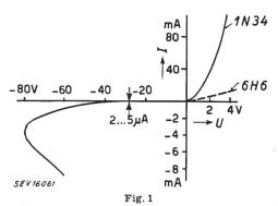
Charakteristik einer Germanium-Kristalldiode 1 N 34 Zum Vergleich: Röhrendiode 6H6
