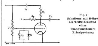
Fig. 7 zeigt eine Prinzipschaltung, in der der veränderliche Innenwiderstand einer Röhre als Teilwiderstand eines Spannungsteilers geschaltet ist. Der Widerstand  $R_1$  und der veränderliche Innenwiderstand der Röhre bilden zusammen den Spannungsteiler.
