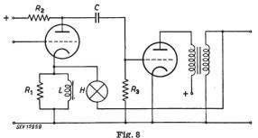
Verzögerte Regelung durch Verwendung eines Heissleiters Prinzipschema
