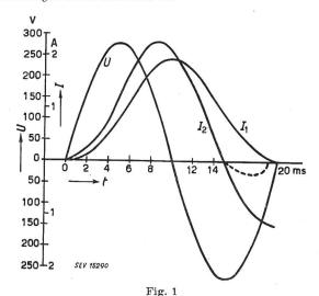
Strom- und Spannungsverlauf bei Einschaltung einer induktiven Belastung
