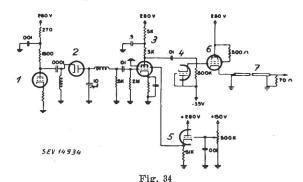
Zwischenfrequenz-Gleichrichter und Bildverstärker
