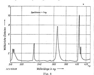
Spektrale Energieverteilung des Lichtbogens der Quecksilber-Höchstdrucklampe HBO 500 im Ultraviolett
