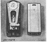
Le thermostat d'ambiance, selon figure, est destiné aux installations automatiques de chauffage. Il comprend un interrupteur unipolaire avec contacts en argent. Le clenchement instantané est obtenu au moyen d'un aimant permanent. La température à obtenir est réglable au moyen d'un disque. Le socle est en matière isolante moulée,
