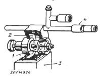
Fig. 26 Sende-Empfangs-Sperre oder Überschlagschalter
