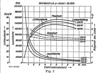
Leuchtdichte, Lichtausbeute und Rotgehalt von kugelförmigen Quecksilber-Höchstdrucklampen in Abhängigkeit vom Elektrodenabstand bei konstanter Lampenleistung und festem Betriebsdruck
