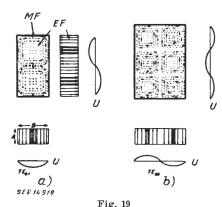
Schwingungsmöglichkeiten in einem Wellenleiter mit rechteekigem Querschnitt
