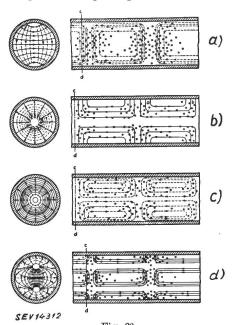
Fig. 20 Schwingungsmöglichkeiten in Wellenleitern mit rundem Querschnitt elektrische Kraftlinien magnetische Kraftlinien
