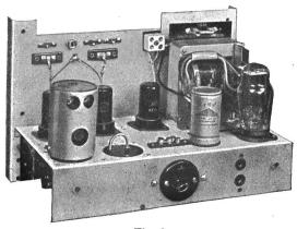
Fig. 3 Albis-Breitband-Antennenverstärker
