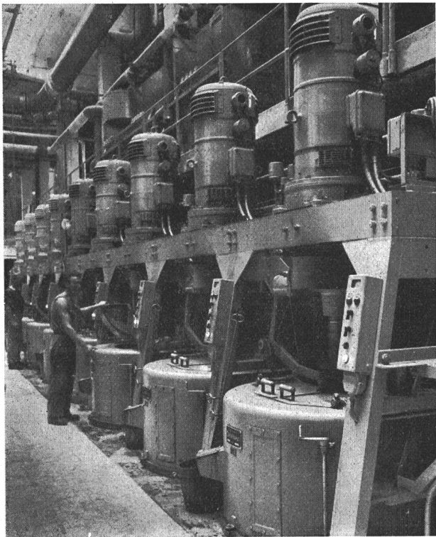
Fig. 2 Glasisolierte Hochleistungszentrifugen in der Zuckerfabrik Aarberg
