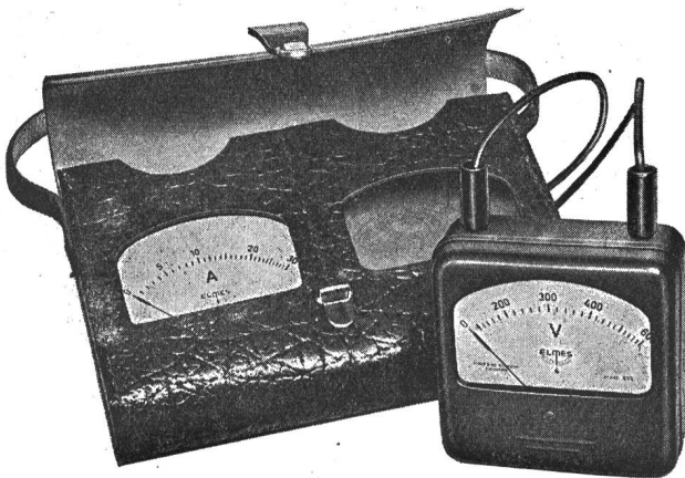
Fig. 3 Elmes 4, tragbare Betriebs- und Laboratoriumsinstrumente
