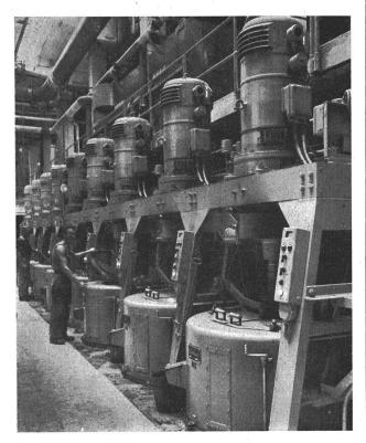
Fig. 2 Glasisolierte Hochleistungszentrifugen in der Zuckerfabrik Aarberg
