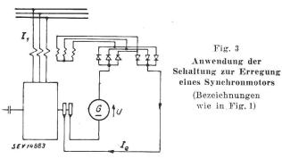
In den Fig. 1 bis 3 ist eine Brückenschaltung der Gleichrichter gewählt, die bezüglich  $I_1$  sowohl für Gleich- als auch Wechselstrom möglich ist. Nach Fig. 4 kann jedoch auch eine Mittelpunktschaltung der Gleichrichter in dem Falle ausgeführt werden, wo  $I_1$  ein Wechselstrom ist.
