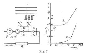
Schaltschema einer Versuchsanordnung an einem Dreiphasen-Wechselstromnetz und zugehörige Kennlinien
