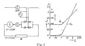
Schaltschema einer Versuchsanordnung an einem Einphasen-Wechselstromnetz und zugehörige Kennlinien
