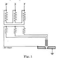
Schaltschema des Drehstrom-Schweissaggregates
