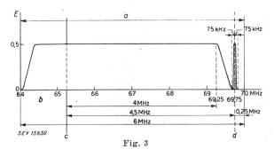
Frequenzband der Fernsehanlage
