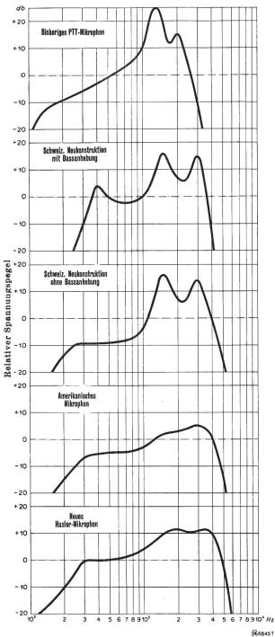
Fig. 2 Übertragungskurve verschiedener Mikrophone
