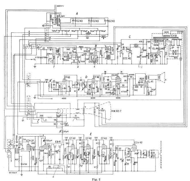
Schaltschema eines Philips Fernseh-Empfängers
