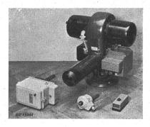
Mise à la terre du point médian de l'enroulement haute tension du transformateur d'allumage. Manœuvre sous tension réduite par appareils SAUTER ou, sous tension réduite de 24 V, par appareils, fabrication Minneapolis Honeywell, dont l'exécution est différente de l'originale. Un contacteur, fabrication Gfeller, est utilisé. Transformateur de faible puissance avec enroulements séparés.
