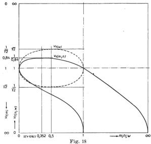
Frequenzwerte für p=1 ( $U_s=konst.$ ) bei einseitig gedämpften (m; n) und symmetrischen Kreisen (w)
