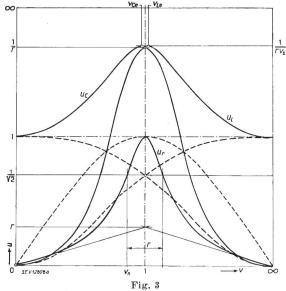
Spannungswerte für  $U_s = \text{konst.}$  (vgl. Fig. 1) Gestrichelt: Grenzkurven für  $r = \sqrt{2}$
