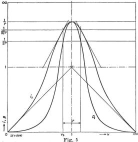
Strom- und Wirkleistungswert für  $U_s = \text{konst.}$
