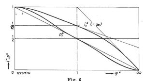
Reduzierter Strom- und Wirkleistungswert in Funktion der reduzierten Verstlumung
