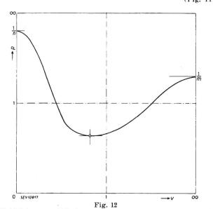
Wirkleistungswert-Verlauf der asymmetrischen Schaltung für  $I_s = \text{konst.}$
