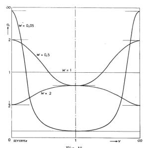
Fig. 10 Wirkleistungswerte der symmetrischen gemischten Schaltung für Is = konst. mit der Dämpfung als Parameter
