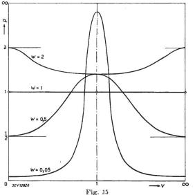
Wirkleistungswerte der symmetrischen gemischten Schaltung für  $U_s =$  konst. mit der Dämpfung als Parameter
