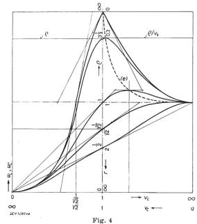
Spannungswerte an der Spule bzw. am Kondensator in Funktion des Frequenzwertes mit der Dämpfung als Parameter Die gestrichelte Kurve (e) ist der geometrische Ort der Extrema
