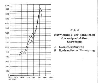
verfügbare Leistung bezifferte sich Ende 1946 für die Wasserkraftwerke auf 2600 MW und für die Wärmekraftwerke auf rund 500 MW. Die thermische Erzeugung, die vor dem Krieg etwa 10 % der Gesamterzeugung betrug, ging auf 2...3 % zurück. Im langjährigen Durchschnitt nahm die Gesamterzeugung jährlich um rund 6,5 % zu.
