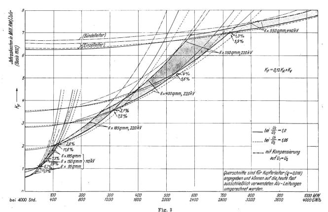
Vergleich mehrerer Hochspannungsleitungen (von 200 km Länge) in bezug auf die wirtschaftlichste übertragbare Leistung (Doppelleitungen) Ermittlung der Betriebsspannung und der Leiterausführung in Abhängigkeit von der übertragenen Leistung
