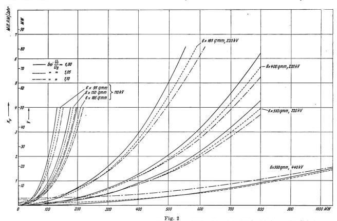
Übertragungskosten verschiedener Hochspannungsleitungen (von 200 km Länge) in Abhängigkeit von der Belastung
