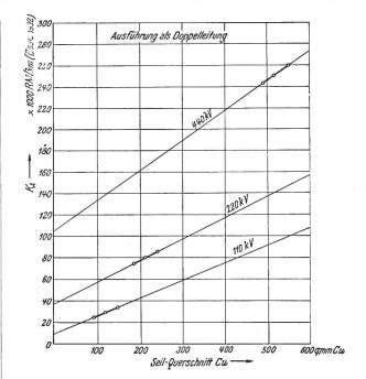
Fig. 1 Anlagekosten von Hochspannungsleitungen in Abhängigkeit vom Querschnitt
