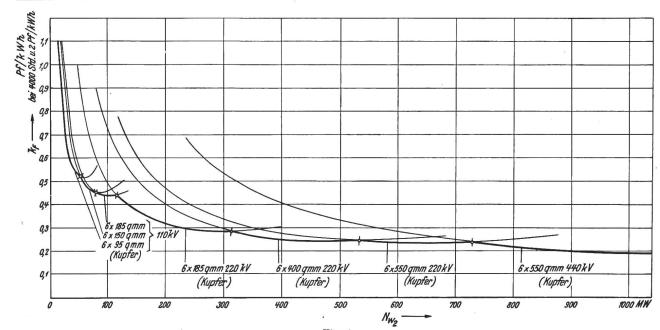
Fig. 4 Ubertragungskosten verschiedener Hochspannungsleitungen (von 200 km Länge) in Abhängigkeit von der Belastung
