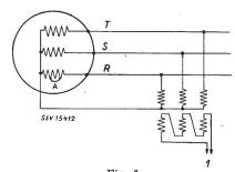
Fig. 6 Generator-Windungsschluss-Schutz Schematische Darstellung 1 Ausgang zum Relais
