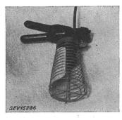
Baladeuse selon figure, comportant une douille filetée E 27, une poignée servant de pince en matière isolante moulée et un panier protecteur en d'acier étamé, avec réflecteur en tôle d'acier vernie blanche. Cette baladeuse est pourvue d'un cordon à gaine de caoutchouc de 5 m, avec fiche bipolaire. L'intérieur de la douille est en céramique.
