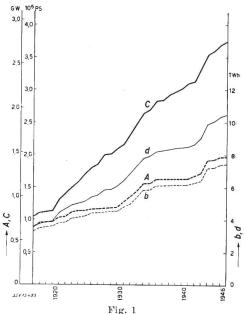
Installierte Leistungen und mögliche Produktion der schweizerischen Wasserkraftanlagen
