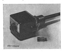
détente. Dès qu'une certaine température est atteinte, la soudure fond et la tige interrompt le circuit sous l'action du ressort. Le socle et la calotte de ces régulateurs sont en matière isolante moulée. La température de déclenchement est réglable par un bouton rotatif.
