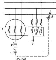
Fig. 7 Generator-Windungsschluss-Schutz Generatornullpunkt geerdet Generator
