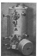
Chauffe-eau à accumulation, selon fig., pour grandes installations de percolateurs. En-clenchement au moyen d'un contacteur commandé par un régulateur de pression. Le réservoir est maintenu, en service, sous une pression d'environ 0,5 kg/cm²; il est ainsi possible de soutirer de l'eau en ébullition ou de la vapeur. Le chauffe-eau est prévu pour le montage dans une armoire comprenant les accessoires nécessaires à la préparation de café, etc.
