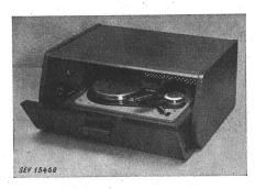
dispositif d'entraînement du fil d'acier et des disques par moteur monophasé à induit en court-circuit, une tête d'enregistrement et de reproduction, ainsi qu'un amplificateur d'enregistrement et de reproduction. Ce dernier comporte un transformateur de réseau à enroulements séparés. Raccordement par cordon rond à deux conducteurs fixé à l'appareil, avec fiche.
