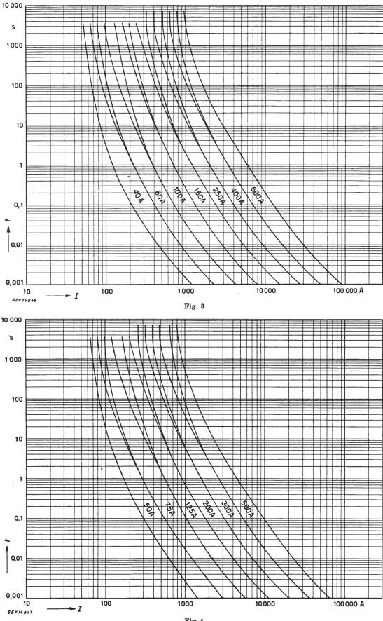
Fig. 4 Caractéristique de fusion des fusibles de coupe-circuit basse tension à haut pouvoir de coupure Degré de retardement II
