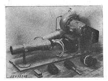
Ce brûleur à mazout a subi avec succès les essais relatifs à la sécurité. Il est conforme au «Règlement pour l'octroi du signe distinctif antiparasite» (Publ. Nº 117 f).
