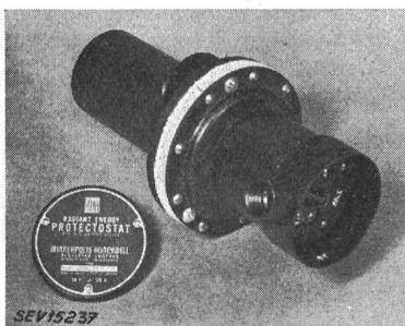
pel. A la poulie est fixé un levier, qui actionne un contact à courant faible. Les parties de contact sont fixées à un socle en matière isolante moulée. L'ensemble du dispositif est logé dans un tube d'acier.
