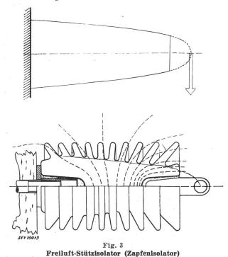
Oben: Form mit gleichmässiger Biegungsbeanspruchung Unten: Stützer mit eingezogenen Elektroden und Schirmen senkrecht zu den Kraftlinien
