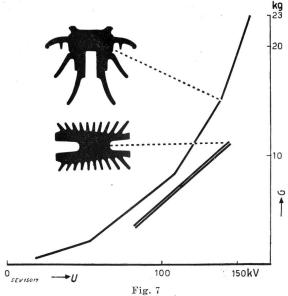
Vergleich des Gewichtes (G) eines Glockenisolators und eines Zapfenisolators in Funktion der Regenüberschlagspannung (U)
