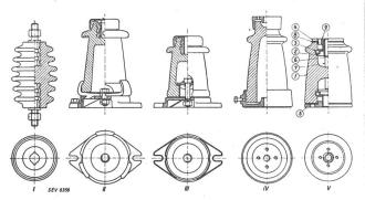
Fig. 1 Verschiedene Stützer-Bauarten
