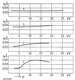
Fig. 6 Spannungsabhängigkeit des Verlustfaktors verschiedener Nut-Isolationen
