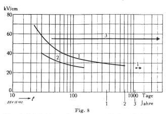
Glimmfestigkeit bis zur Zerstörung verschiedener Isolationen Durchschlagfestigkeit in Funktion der Beanspruchungsdauer 1 Spezialpapier mit asphaltähnlichem Lack verarbeitet; 2 Triacetat-Isolation; 3 Nutisolation mit Glimmer
