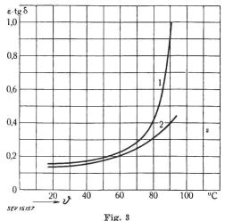
Temperaturabhängigkeit der Verlustziffer einer Isolation mit grossen dielektrischen Verlusten
