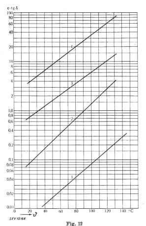
Temperaturabhängigkeit der Verlustziffer, Durchschlagfestigkeit und Wärmebeständigkeit einiger Isoliermaterialien
