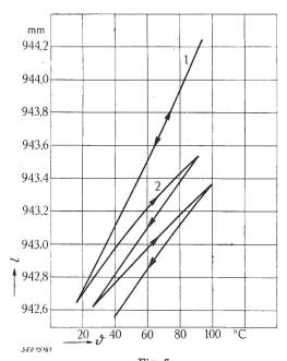
Fig. 7 Längen des Kupferleiters und der Isolationsschicht (6 mm) in Funktion der Temperatur
