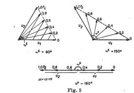
Vektorielle Darstellung der Veränderung der Beschleunigungsspannung beim Übergang vom ersten zum zweiten Hochfrequenzgenerator
