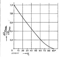
Abhängigkeit der maximal zulässigen Abweichung der Winkelgeschwindigkeit der Teilchen vom Synchronwinkel φ<sub>s</sub> Synchronwinkel der zu beschleunigenden Teilchen,  $\Delta\Omega_{as max}/\Delta\Omega_{a max}$  relative Anderung der maximal sigen Abweichung von der Winkelgeschwindigkeit der Teilchen
