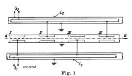
Prinzipielle Darstellung eines Hochfrequenz-Beschleunigungsapparates (Synchrotron, Gigator), in linearer Darstellung A-B Laufweg der geladenen Teilchen, I...IV Beschleunigungsstrecken, L<sub>1</sub>, L<sub>2</sub> koaxiale Leiter, G<sub>1</sub>, G<sub>2</sub> Anschlussklemmen für Hochfrequenzgeneratoren
